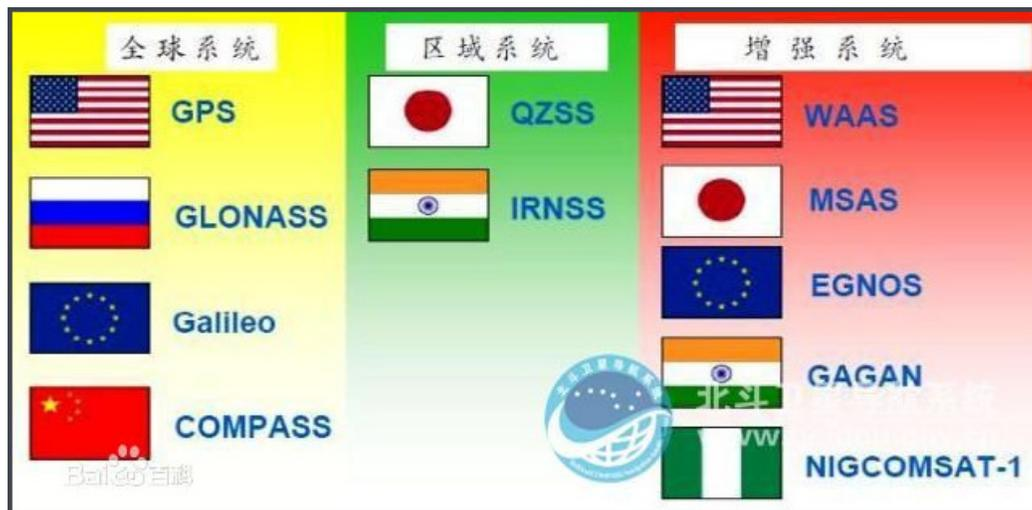
中国北斗卫星导航系统 (BeiDou Navigation Satellite System-"BDS") 是我国自行研制的全球卫星定位与通信系统。是继美国全球卫星定位系统 (Global Positioning System-"GPS") 和俄罗斯全球卫星导航系统 (GLONASS) 之后第三个成熟的卫星导航系统。系统由空间端、地面端和用户端组成, 可在全球范围内全天候、全天时为各类用户提供高精度、高可靠定位、导航、授时服务, 并具短报文通信能力, 已经初步具备区域导航、定位和授时能力, 定位精度优于 20m,
