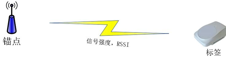
由于位置不同，一般而言，距离越远，锚点收到标签的信号强度就越弱，可以通过信号强度值，来估算 Wi-Fi 锚点和标签之间的距离。
