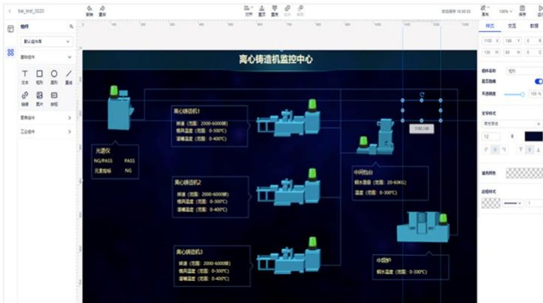
图. 东智工业物联平台组态工具
